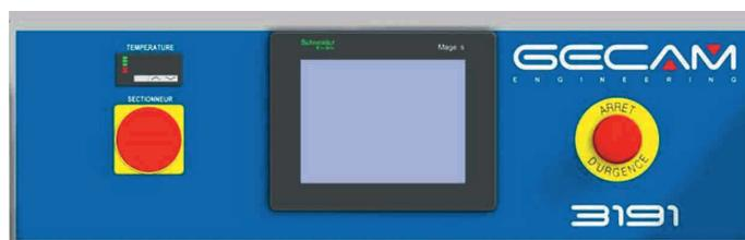
Tableau de commande équipé d'un écran tactile 6" (étanche IP 65) permettant de :
